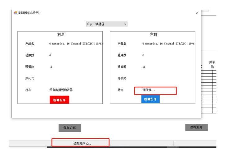
以点击"检测左耳"为例,验配师点击以后,状态会显示未"请稍候",在检测过程中,中间状态栏会显示状态信息,在正常运行的情况下,会显示"连接助听器","读取程序: 1...","读取程序:2...","完成"等字样,等到编程器指示灯不再闪烁,状态栏会显示"读取助听器参数成功".顶部的"保存"按钮和程序选择下拉框呈激活状态。
