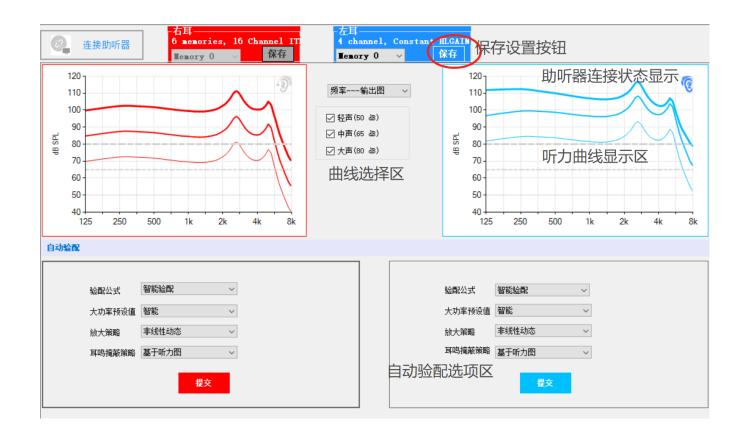
听力曲线区:会显示目标曲线和助听器设备的实际曲线。其中目标曲线是根据用户的听力数据和年龄性别等资料,使用验配公式计算出来的。实际曲线是助听器设备当前的有效频率-输出曲线。在验配师调节过程中,实际曲线应该在听取用户反馈的前提下,应可能拟合目标曲线,但不能超过目标曲线的值。
